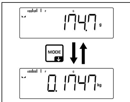
⇒ Mit der **[MODE]**-Taste kann zwischen der aktiven Einheit 1 und Einheit 2 umgeschaltet werden.
