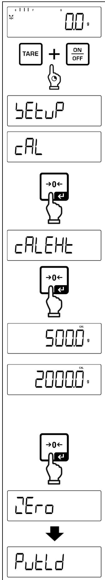
⇒ Zum Aufrufen des Setup-Menüs TARE- und ON/OFF-Taste gleichzeitig drücken und gedrückt halten.
