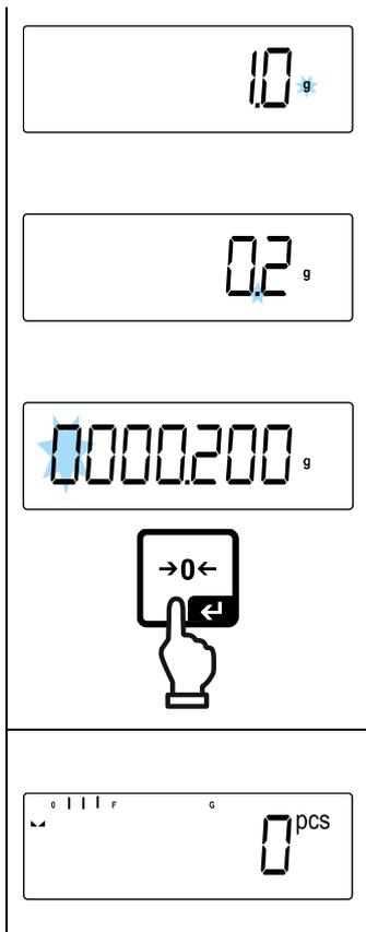
⇒ Mit den Navigationstasten ↓↑ die Position des Kommas auswählen und mit [ ← ]-Taste bestätigen.
